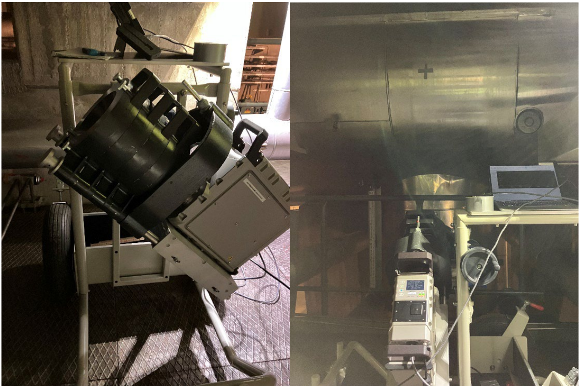
Figur 4: Mätuppställning med bärbar HPGe.
