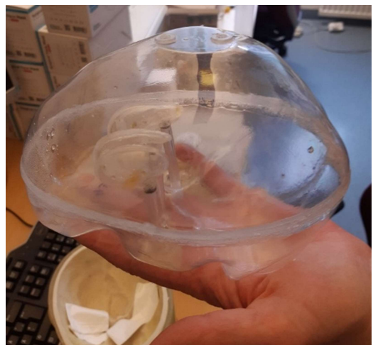
Det går att ta ut plasthjärnan och fylla den med aktivitet. Strukturen som efterliknar de basala ganglierna fylls med extra aktivitet för att efterlikna en riktig DaTSCAN-undersökning.
