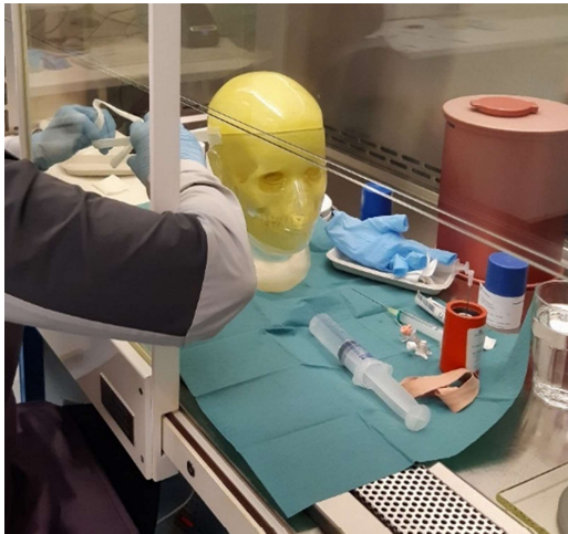
De båda strukturerna som efterliknar de basala ganglierna fylls med en mörkblå lösning som innehåller I-123. Lösningens koncentration är beräknad för att stämma med den aktivitet som tillförs till resten av hjärnan för att efterlikna bakgrunden.
