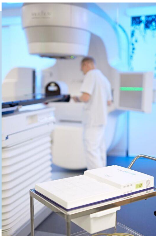
Magnus Karlsson riggar för kontroll av en linjäraccelerator. Fotograf: Joakim Jonsson
