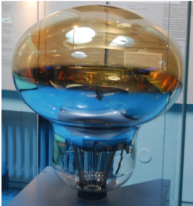
Fotomultiplikator - fler än 11200 st användes för neutrinoexperiment.
