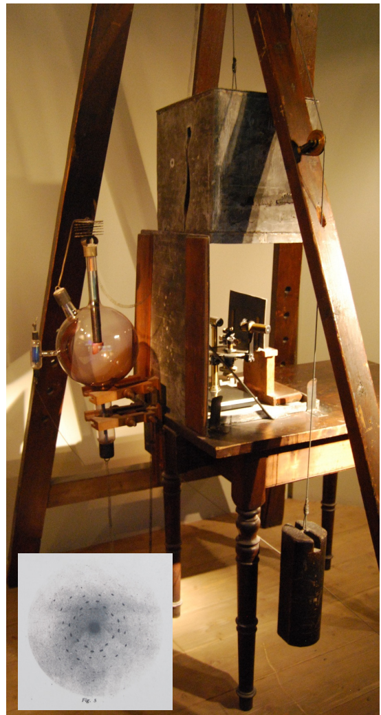
Experimentuppställning för röntgenstrukturanalys 1912. Infällt: interferensmönster.
